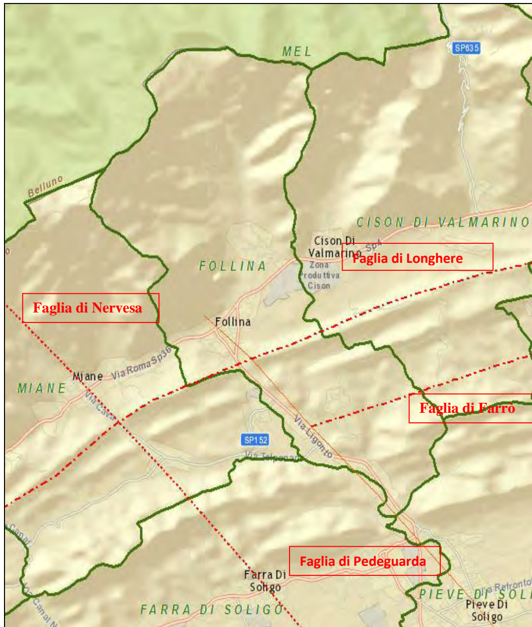
Fig. 3 Cartografia con indicate le faglie capaci che interessano il Comune di Follina desunte dall'archivio ITHACA.
